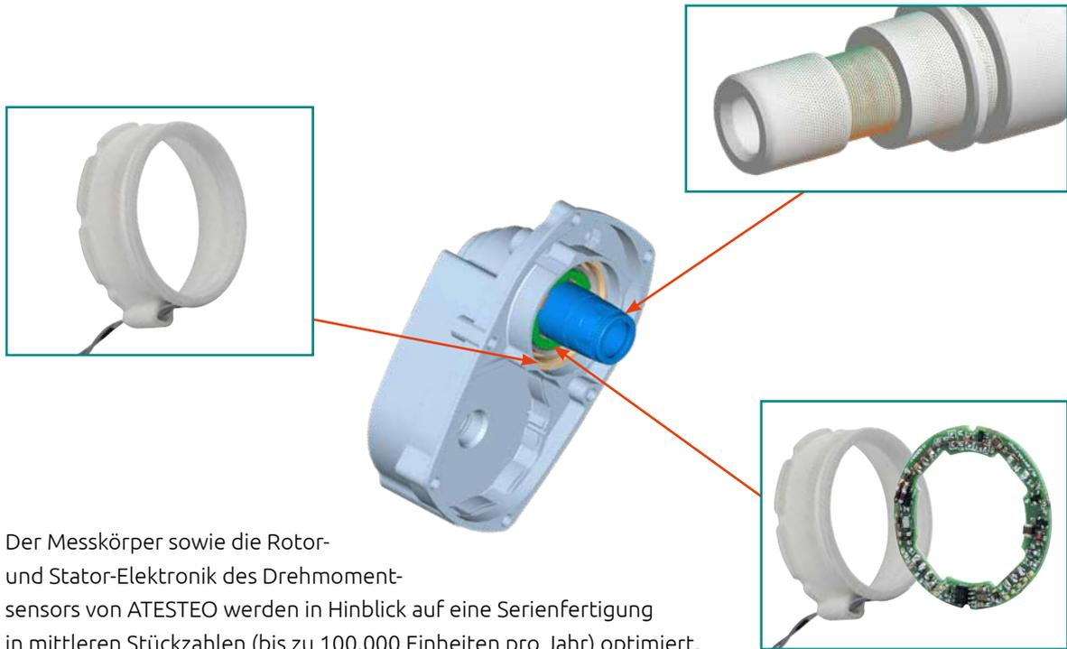
Der Messkörper sowie die Rotor- und Stator-Elektronik des Drehmoment-sensors von ATESTEO werden in Hinblick auf eine Serienfertigung in mittleren Stückzahlen (bis zu 100.000 Einheiten pro Jahr) optimiert.
